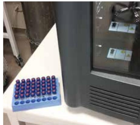
25. Laden Sie die Fläschchen und führen Sie eine LC-MS/MS-Analyse durch.
