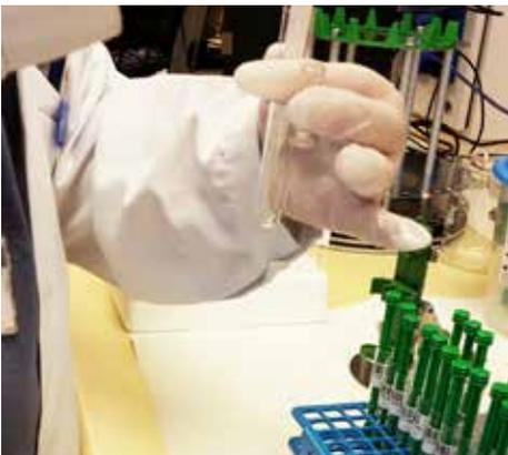
24. Lösen Sie das Extrakt neu in LC-Puffer auf und überführen Sie es in ein Autosamplere-Fläschchen.
