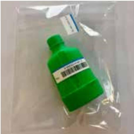
1. BE Probensammel-Gerät verpackt in einem Plastikbeutel. Der Beutel ist mit einem Proben-ID-Etikett verschlossen, das mit dem entsprechenden Chain-of-Custody Dokument übereinstimmt.
