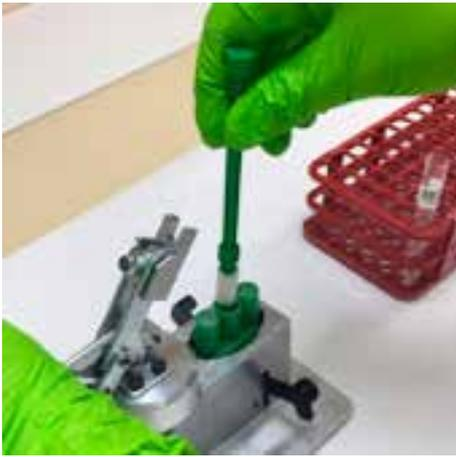
13. Lösen Sie den Druck und nehmen Sie den Pick Stick, der jetzt den Kollektor hält (Probe A), heraus.
