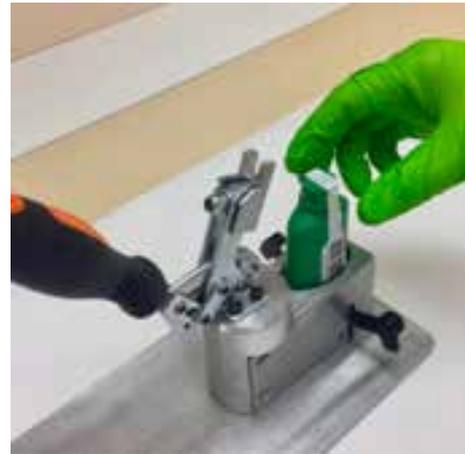
8. Drücken Sie das Gerät nach unten, bis Sie ein „Klick“ hören und das Gerät unten bleibt.
